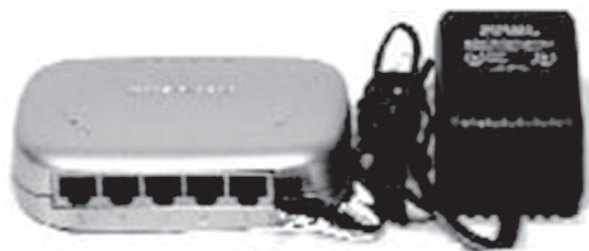
Slika 21: Mrežni razdjelnik sa napajanjem (eng. Switch).
